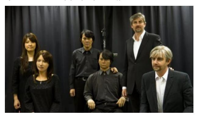
Андроид **Geminoid-F** (первый слева), способен полностью повторять мимику своего оператора или любого другого человека, если лицо последнего снимается на камеру, подключенную к встроенным в тело Geminoid-F электродам. Именно благодаря таким сигналам робот способен воспроизводить улыбку, громко смеяться и хмурить брови.
